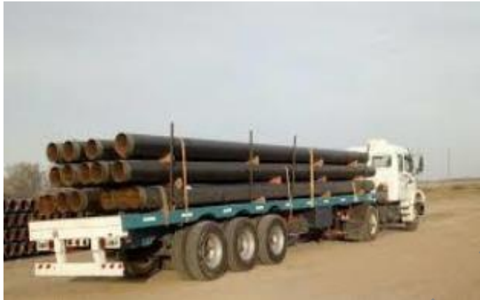
Figura 1--7. Ejemplo de acarreo de tubería
